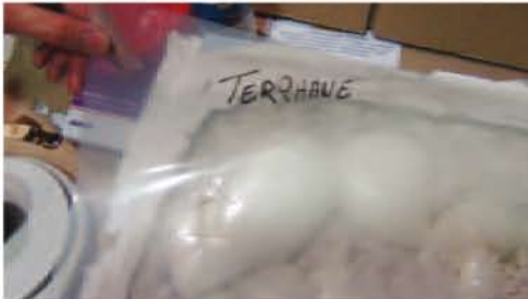
8 Mettre un film de terphane sur la mousse en expansion pour avoir un fond lisse
