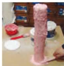
8 La couche de silicone doit être régulière
